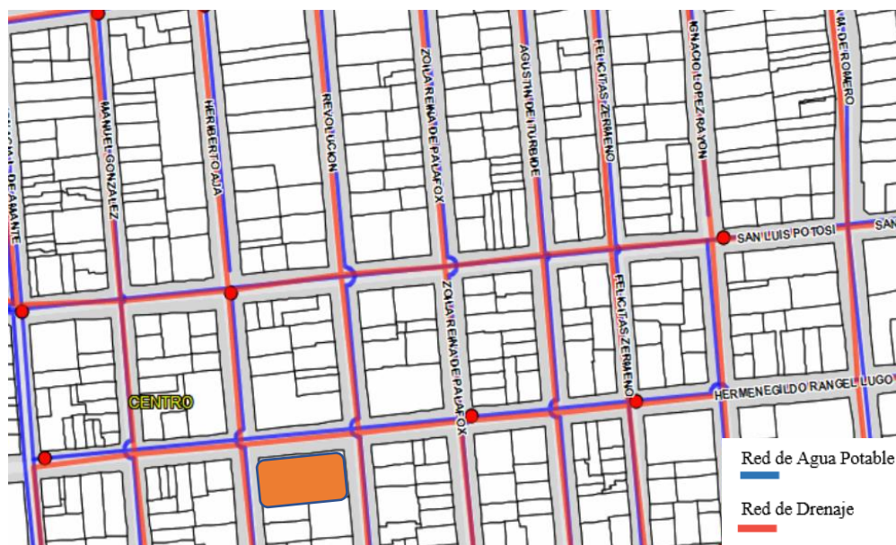
Ilustración 7 V.4 Infraestructura de drenaje y agua potable
